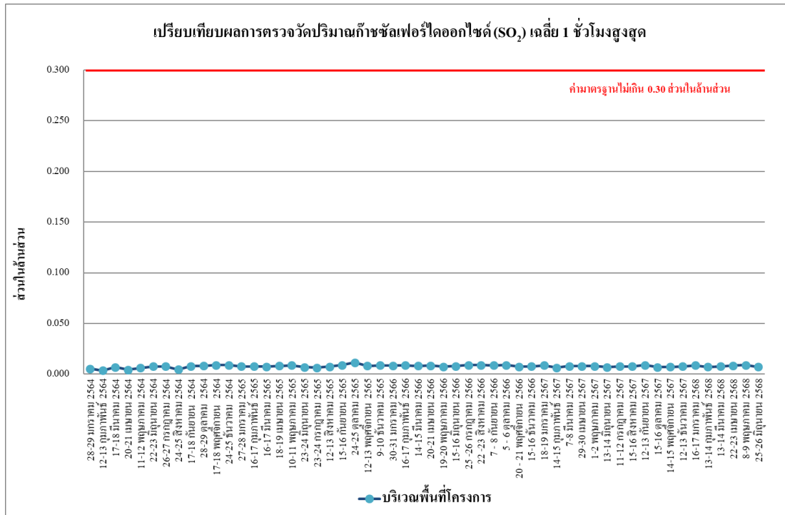
รูปที่ 4.4-18 เปรียบเทียบผลการตรวจวัดปริมาณก๊าซซัลเฟอร์ไดออกไซด์ (SO 2 ) เฉลี่ย 1 ชั่วโมงสูงสุด บริเวณพื้นที่โครงการ ระหว่างเดือนมกราคม 2564-มิถุนายน 2568
